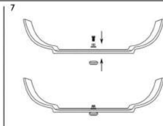
Зафиксируйте 2 крепежные шпильки с обратной стороны декоративной решетки (рис.4).
