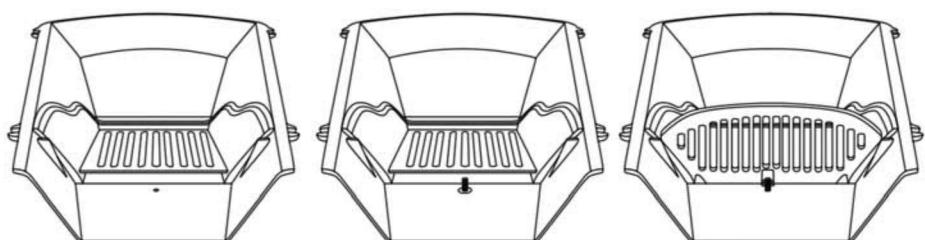
Положите топливник на ровную поверхность. Поместите огнеупорный камень на место и затем вставьте болт в отверстие прямо под ним. Вставьте колосник в пазы топливника над гайкой M6. Закрепите с помощью шайбы M6 и болта M6.
